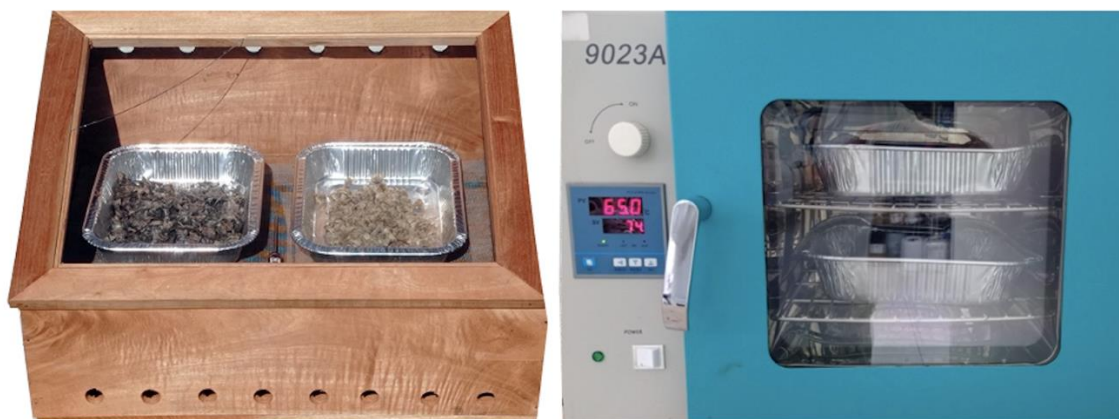
Figura 1 Procesos de secado de pez diablo en secador solar (izquierda) y con horno de secado (derecha)
