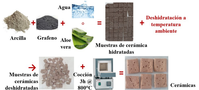
Fig. 2. Proceso de producción de los compuestos grafeno-cerámicos.
